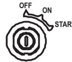
Inserire la chiave di avviamento (Q1), ruotarla completamente in senso orario lasciandola appena il motore dà i primi scoppi.
