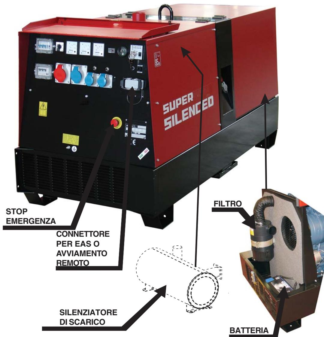
Il gruppo è composto da: un basamento strutturato che congloba un serbatoio, un gruppo motore-alternatore fissato sul basamento da 4 ammortizzatori elastici, un roll-bar con gancio per un facile e sicuro sollevamento, un cofano incernierato al roll-bar per un accesso rapido al motore, al filtroaria e alla batteria. Completa il gruppo un frontale, protetto da un coperchio, dove vengono montate le prese, le protezioni e gli strumenti di misura.
