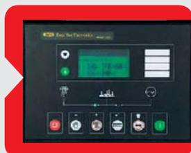
La centralina elettronica 7320 permette la gestione della modalità automatica del gruppo elettrogeno grazie alla funzione di rilevamento della mancanza rete. Mediante il display LCD è possibile monitorare il funzionamento dl gruppo elettrogeno.
