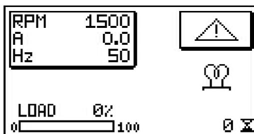
Il comando a distanza è uno strumento per l'avvio, l'arresto e la visualizzazione dei parametri del generatore.
