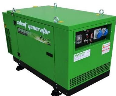
In acciaio, verniciata a polveri epossidiche RAL6018, per garantire un ottimale resistenza alla corrosione. Materiale fonoassorbente resistente al fuoco ad alto abbattimento acustico. Ottima accessibilità per manutenzioni ordinarie/straordinarie. Marmitta silenziatrice interna alla cofanatura.
