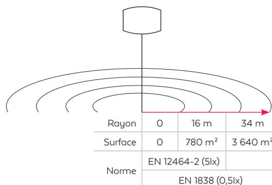
Comprendre le schéma : dans un rayon d'action de 34 m, soit une surface de 3 640 m<sup>2</sup>, nous garantissons un éclairage conforme à la norme EN1838.
