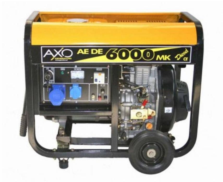
Il gruppo elettrogeno AEDE 6000MK, semisilenziato monofase 220 V eco diesel, è dotato di regolatore di giri meccanico a masse centrifughe, alternatore monofase, valore di distorsione T.H.D. inferiore al 6% e precisione della tensione compresa tra +2% e -2%. Il gruppo viene fornito con il kit di movimento e sollevamento di serie.
