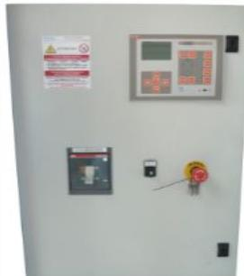
Centralina RGK800 con multmetro (voltmetro, amperometro, frequenzimetro, contaore e voltmetro batteria). Caricabatteria, funzione test periodico e riferimenti di rete. Moduli di espansione EXP ed ingresso analogico programmabile.
