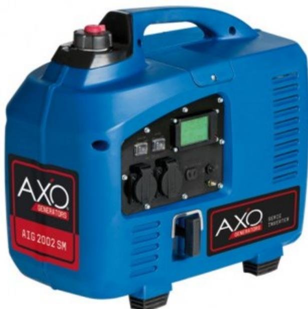
Il generatore inverter con motore a benzina AIG 2002SM è dotato di alternatore multifase + scheda inverter con uscita monofase 220 V. stabilizzata. Il valore di distorsione T.H.D. è inferiore al 2%, la precisione della tensione è compresa tra +1% e -1%.
