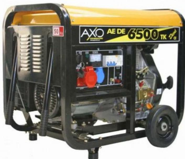
Il gruppo elettrogeno semisilenziato trifase 380/220 V eco diesel AEDE 6500TK è dotato di regolatore di giri meccanico a masse centrifughe, alternatore trifase con neutro accessibile, valore di distorsione T.H.D. inferiore al 6% e precisione della tensione compresa tra +1,5% e -1,5%. Il gruppo viene fornito con il kit di movimento e sollevamento di serie.
