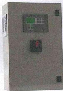
QE con centralina elettronica di comando e controllo Alternatore e Motore. Previsto il controllo interno presenza rete. In modalità AUTO alla mancanza rete, effettua l'avviamento del GE e automaticamente comanda lo scambio rete/gruppo. In alternativa può essere avviato da contatto remoto o in modalità MAN. Provvisto di selettore a chiave per attivazione logica, cicalina tacitabile, caricabatteria automatico, ed interruttore magnetotermico con manovra in
