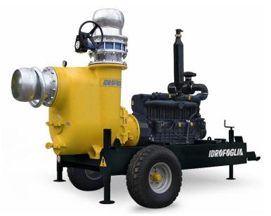
Pompa centrifuga autoadescante utilizzata per il drenaggio di terreni e qualsiasi altra operazioni di movimentazione di acque e fanghi bentonitici. Il pompaggio dell'acqua con sabbie o ghiaia è possibile grazie alla robustezza dell'idraulica e dall'ampio passaggio dei solidi nella girante.
