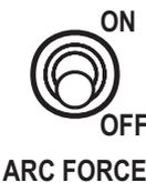
Das gleiche Ergebnis wird mit dem Schalter "arc force" erreicht, (jedoch ohne die Regulierung), indem man den Hebel von ON auf OFF stellt.
