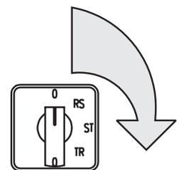
Controllare le tensioni sulle varie fasi selezionate con il commutatore posto sul frontale (H2) e controllare leggendo sul voltmetro (N), circa, lo stesso valore di tensione.
