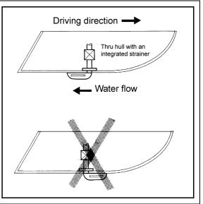
Fig. B.3.2-1: Thru/vessel fitting
