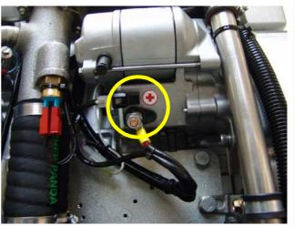
Fig. B.7.1-1: Connection positve battery cable
