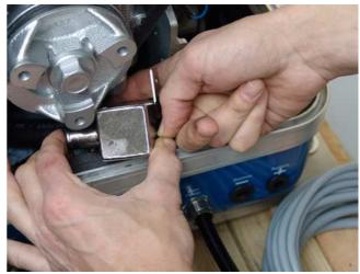
Fig. H.3-7: Remove Impellerfilter
