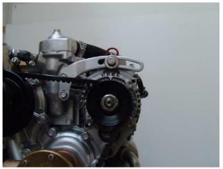
Fig. A.3.6-6: DC-alternator
