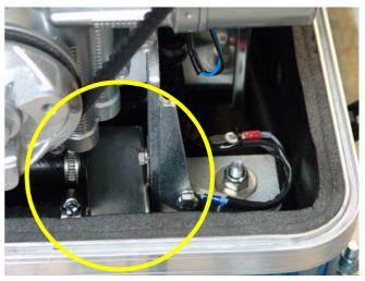
Fig. H.3-1: Impellerfilter
