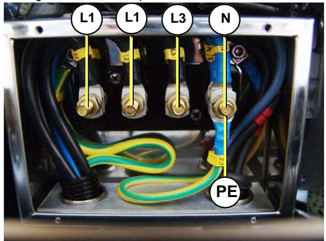
Fig. 8.5.0-8: Wiring diagram HP3 - 240 V / 60 Hz
