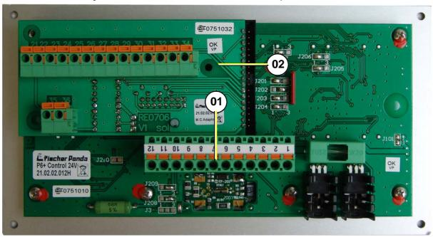
Fig. 12.7.2-1: Panel 21.02.02.012H with master-slave adapter 21.02.02.015H
