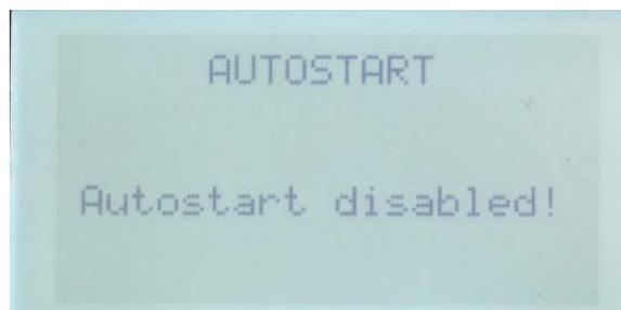
L'activation ou la désactivation de la fonctionnalité de démarrage automatique est sauvegardée dans l'EEPROM du panneau de commande.
