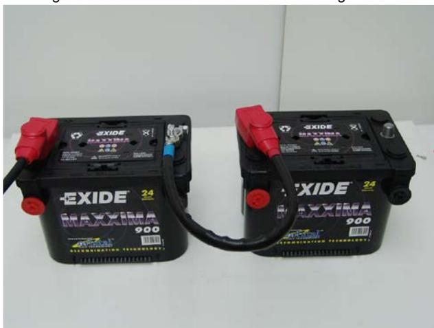
4. raccorder le câble (-) du générateur à la première batterie
