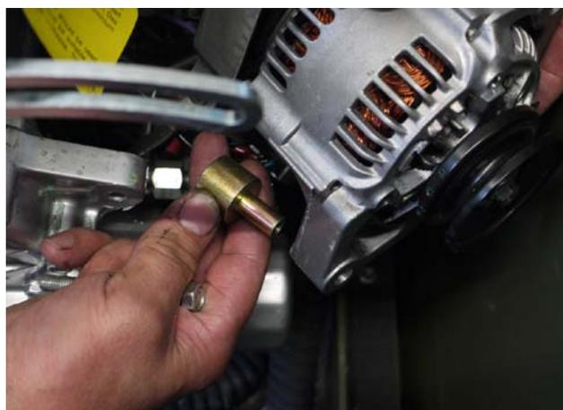
14. Desserrer et retirer la bande de mise à la terre avec une clé à douille 5 mm
