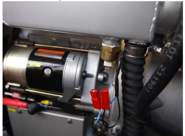
4. Desserrer le thermorupteur avec une clé à douille de 22 puis le retirer.
