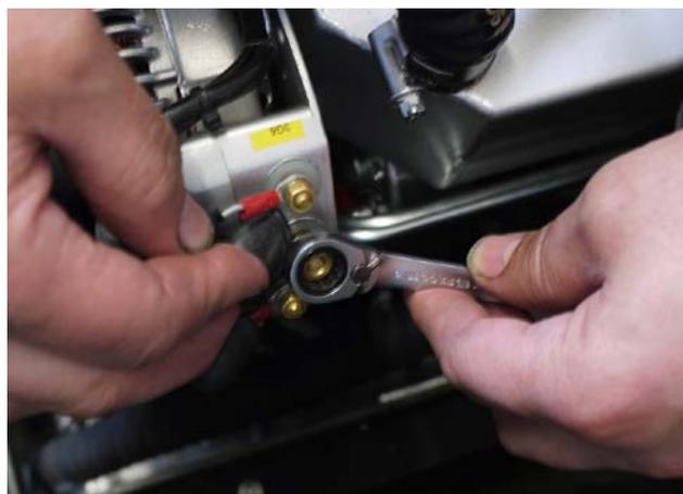
5. Dévisser l'écrou et la rondelle du raccord d'excitation (câble gris) avec une clé à douilles de 8 mm.
