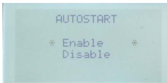
Pour activer la fonctionnalité de démarrage automatique, sélectionner l'option "Enable" et confirmer par la touche Start/Stop.
