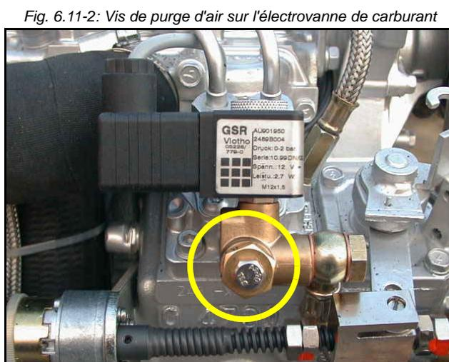
Fig. 6.11-2: Vis de purge d'air sur l'électrovanne de carburant
