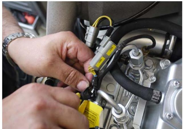
5. Desserrer le thermorupteur avec une clé à douille de 14 puis le retirer.
