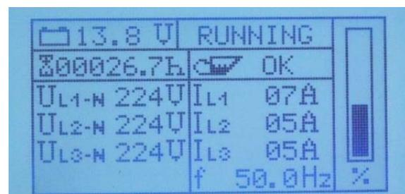
Sur cette page, on voit des tensions de conducteurs extérieurs de l'inverseur. On atteint la page inverseur en actionnant la touche de défilement vers le haut en mode de fonctionnement.
