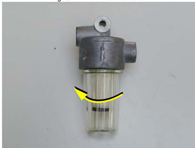
Sortir l'élément filtrant du support (rotation à gauche)
