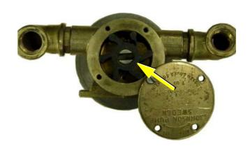
Fig. 7.22.1-5: Impeller
