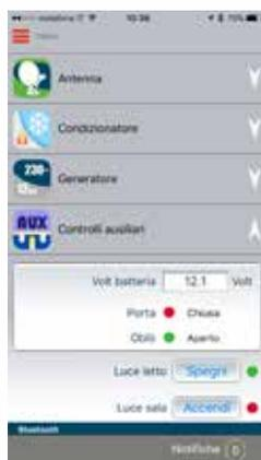
Accendere o spegnere il climatizzatore Telair, sia in raffreddamento che in riscaldamento, per rendere confortevole la temperatura al vostro rientro nel veicolo.
