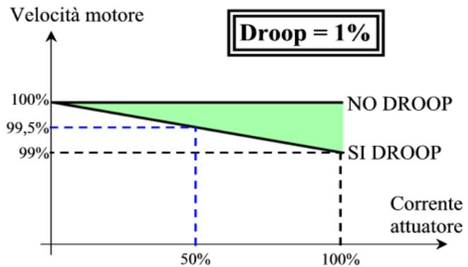
*Esempio: Il Set Nominale Giri (P.000) è impostato su 1500rpm, la Massima Corrente (P.010) su 6Adc, la Droop (P009) su 1%. All'aumentare della corrente sull'attuatore il set di giri è decrementato in maniera lineare finché con una corrente di 6Adc sull'attuatore il set di rotazione è pari a 1485rpm. Se invece la corrente sull'attuatore è 3Adc, il set di rotazione è pari a 1492rpm.*
