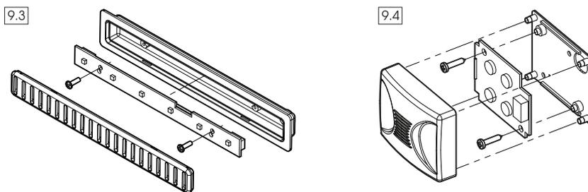
Per effettuare la sostituzione della scheda luce led, in entrambe le tipologie di scheda (Fig. 9.3 & Fig. 9.4), procedere come segue:
