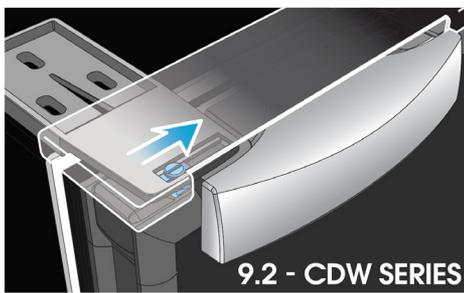
Per mettere la porta in "Vent Position", premere con entrambe le dita i due pulsanti ed estrarre il meccanismo dalla staffa superiore nei modelli DW (Fig. 9.1), spostare verso l'interno il perno della cerniera centrale nei modelli CDW (Fig. 9.2).
