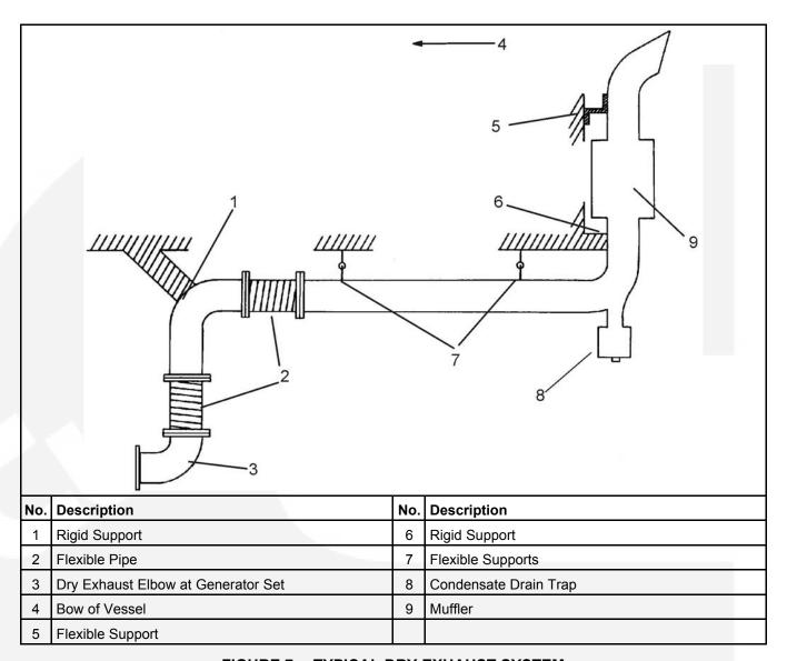
FIGURE 7. TYPICAL DRY EXHAUST SYSTEM
