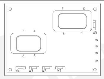
FIGURE 10. NIM CONFIGURATION JUMPERS
