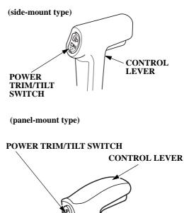
(top-mount type) SINGLE TYPE POWER TRIM/TILT SWITCH CONTROL LEVER DUAL TYPE POWER TRIM/TILT SWITCH (LEFT) (RIGHT)
