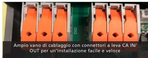
Ampio vano di cablaggio con connettori a leva CA IN/OUT per un'installazione facile e veloce
