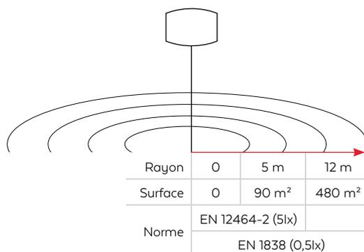
Comprendre le schéma : dans un rayon d'action de 12 m, soit une surface de 480 m<sup>2</sup>, nous garantissons un éclairage conforme à la norme EN1838.
