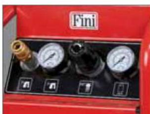
Comandi centralizzati nel pannello di controllo.
