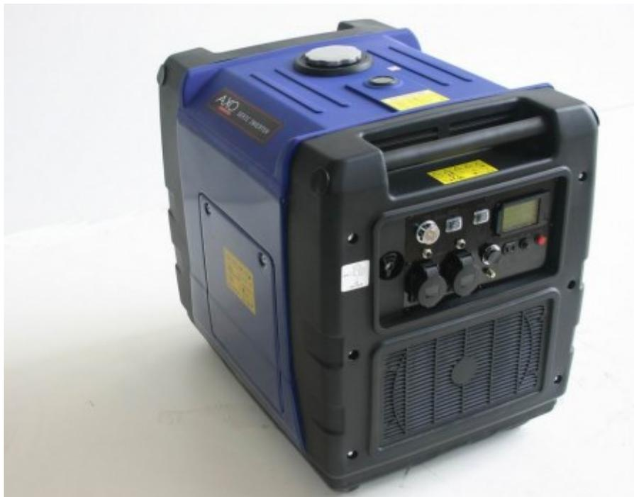
Il gruppo elettrogeno inverter con motore a benzina AIGE 3002SMP è dotato di alternatore multifase + scheda inverter con uscita monofase 220 V. stabilizzata. Il valore di distorsione T.H.D. è inferiore al 2%, la precisione della tensione è compresa tra +1% e -1%.
