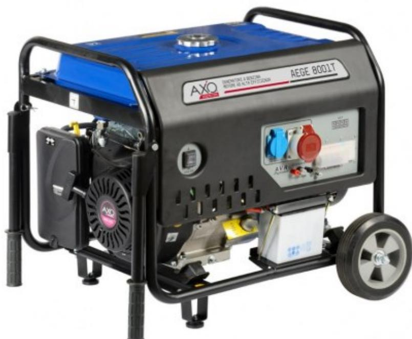
Il gruppo elettrogeno semisilenziato con motore a benzina AEGE 8001T è dotato di un alternatore trifase con un valore di distorsione T.H.D. inferiore al 6% e precisione della tensione compresa tra +1,5% e -1,5%. Su questo modello viene proposto di serie il kit di movimento e sollevamento del gruppo. Tale kit viene applicato direttamente sul basamento.
