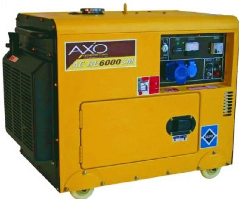
Il Generatore silenziato eco diesel AEDE 6000SM è dotato di motore diesel con regolatore di giri meccanico a masse centrifughe, alternatore monofase a regolazione elettronica (AVR), valore di distorsione T.H.D. inferiore al 6% e precisione della tensione compresa tra +2% e -2%. Il gruppo viene fornito con il kit movimento di serie.
