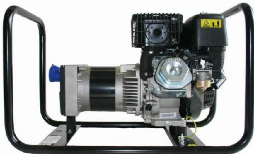
Il generatore aperto da cantiere a benzina ACG 5000M è dotato di alternatore monofase prodotto e costruito in Italia, valore di distorsione T.H.D. inferiore al 6% e precisione della tensione compresa tra +5% e -10%.
