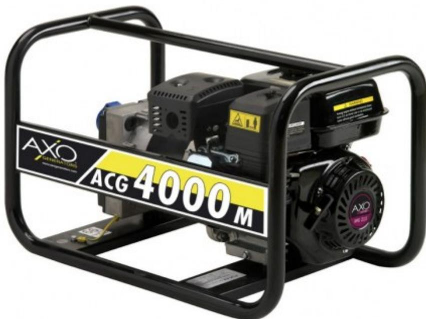
Il modello ACG 4000M è un generatore di corrente aperto per cantiere dotato di un alternatore monofase di produzione e costruzione italiana, valore di distorsione T.H.D. inferiore al 6% e precisione della tensione compresa tra +5% e -10%.
