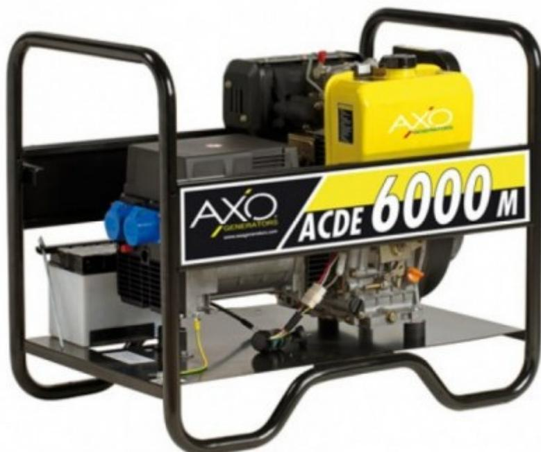
Il gruppo elettrogeno da cantiere ACDE 6000M è dotato di motore diesel e di un alternatore monofase prodotto e costruito in Italia, ha valore di distorsione T.H.D. inferiore al 6% e precisione della tensione compresa tra +5% e -10%.
