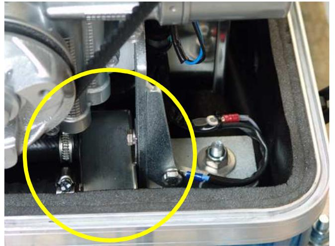
Fig. H.3-1: Impellerfilter
