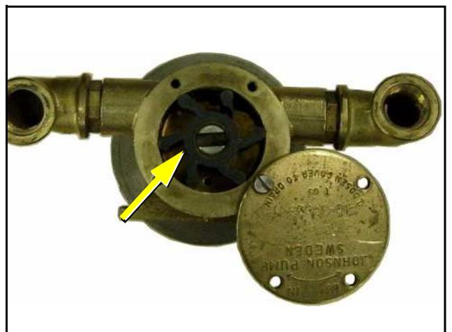
Fig. D.9.1-4: Impeller
