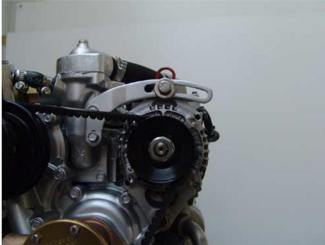
Fig. A.3.6-6: DC-alternator
