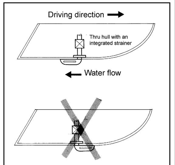
Fig. B.3.2-1: Thru/vessel fitting
