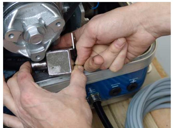
Fig. H.3-7: Remove Impellerfilter
