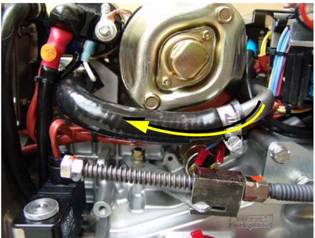
Fig. A.3.2-6: Coolant pipe
