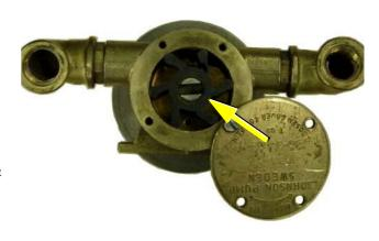
Fig. 7.17.1-5: Impeller
