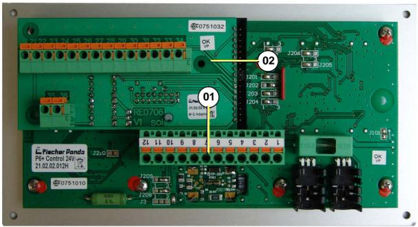
Fig. 11.8.2-1: Panel 21.02.02.012H with master-slave adapter 21.02.02.015H
