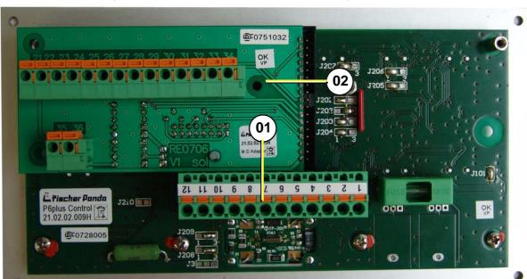
Fig. 11.8.1-1: Panel 21.02.02.009H with master-slave adapter 21.02.02.015H
