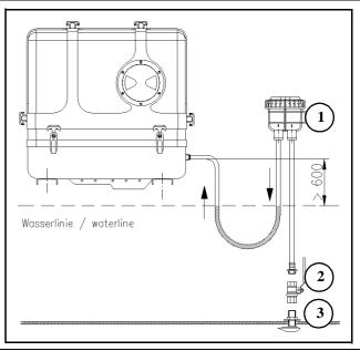
Fig. A.3.4-1: Einbau des Generators über der Wasserlinie
