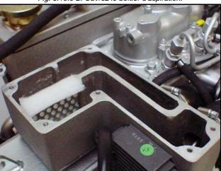
Fig. 6.10.0-2: Ouvrez le boîtier d'aspiration.
