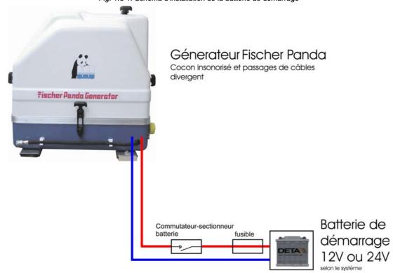
Fig. 1.6-1: Schéma d'installation de la batterie de démarrage
