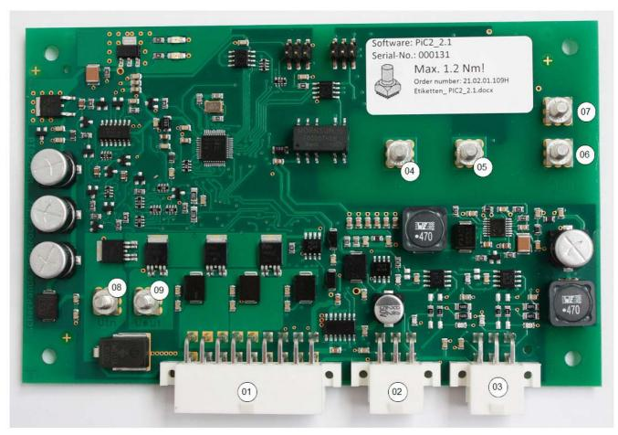
La platine de commande Panda iControl2 est reliée à l'arbre de câblage par un multi-connecteur de 18 pôles Le connecteur central de 6 pôles est destiné au bus standard Fischer Panda. La platine Panda iControl est raccordée à ce connecteur Le bus CAN Fischer Panda est raccordé au connecteur à 6 pôles situé sur la platine en bas à droite Le tableau suivant indique les occupations des connecteurs Siehe "Occupation des connecteurs de la platine de commande Panda iControl2" auf Seite 160.
