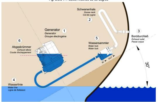
Fig. 5.5.6-7: Position inclinée de 30 degrés
