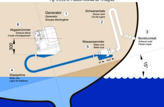
Fig. 5.5.6.2-6: Position inclinée de 15 degrés
