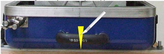
Coupez le tuyau en caoutchouc à destination de la soupape d'aération externe...
