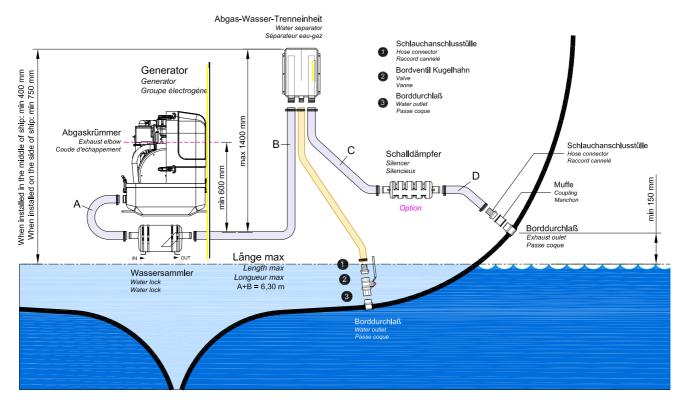
Fig. 5.5.8-1: Installation Abgas-Wasser Trenneinheit
