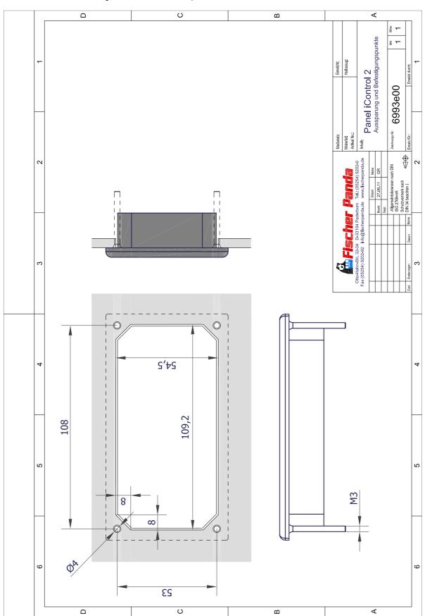
Fig. 13.3.0-1: Boîtier due la platine de commande Panda iControl2
