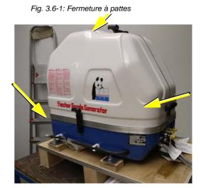
Pour ouvrir le cocon insonorisé, tirez les pattes de fermeture dans la direction de la flèche et soulevez-les. Après l'ouverture de tous les dispositifs de fermeture, la partie supérieure du cocon peut être séparée de la partie inférieure par soulèvement.
