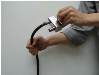
Alternative: nettoyage du tamis de la turbine à l'air comprimé
