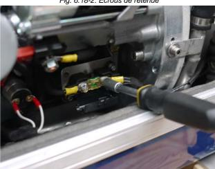
Fig. 6.18-2: Écrous de retenue
