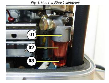
Fig. 6.11.1.1-2: Filtre à carburant
