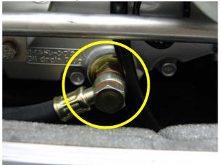
Fig. 6.13-5: Joint d'un filtre d'huile
