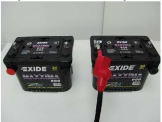
Fig. 5.8.4.1-1: Installation batterie de démarrage de 24V
