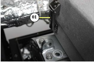
Fig. 6.8-3: Remplacement du filtre à air
