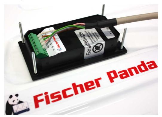
Fig. 13.2.1-1: Platine de Panda iControl2 avec le câble de raccordement et boîtier fermé
