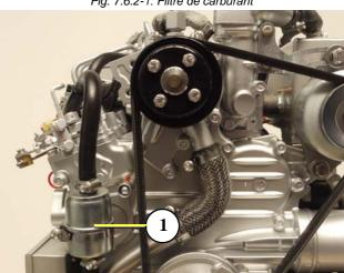
Fig. 7.6.2-1: Filtre de carburant
