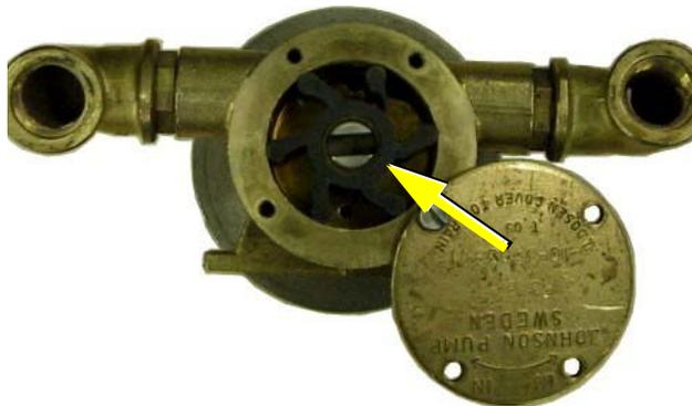
Fig. 7.22.1-5: Impeller
