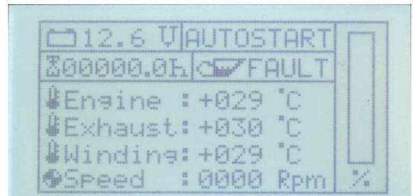
La fonctionnalité d'Autostart reste active même à la suite d'un arrêt et d'une remise en service de la commande par la touche On/Off. En vue de désactiver la fonctionnalité d'Autostart il faut enlever le fanion de l'EEPROM par "Disable" Voir "Activation et désactivation de la fonctionnalité de démarrage automatique („Autostart“)" à la page 14.
