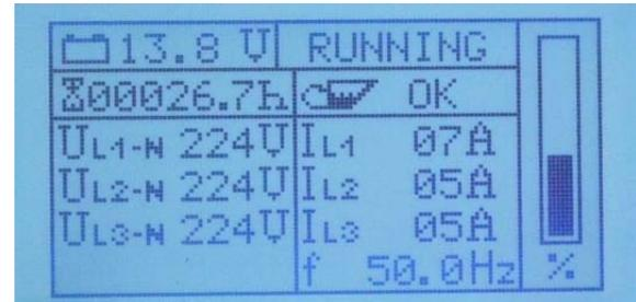
Sur cette page, on voit les tensions de conducteurs extérieurs de l'inverseur. On atteint la page inverseur en actionnant la touche de défilement vers le haut en mode de fonctionnement.
