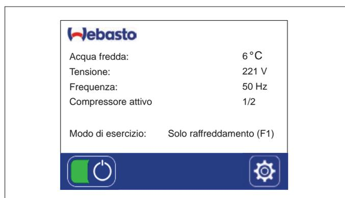
**Fig.19 Esempio schermata iniziale unità Chiller senza comando in cabina**
