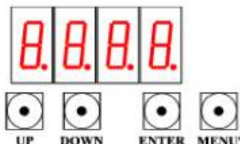
**Menù:** permette di cambiare i parametri (d, r, I, P)
