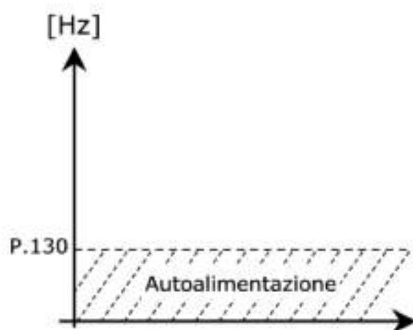
Con P.250=0 al di sotto della minima frequenza dell'alternatore l'uscita viene disabilitata.
