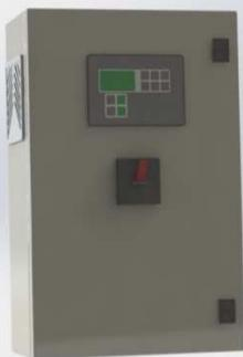
QE con centralina elettronica di comando e controllo Alternatore e Motore. Previsto il controllo interno presenza rete. In modalità AUTO alla mancanza rete, effettua l'avviamento del GE e automaticamente comanda lo scambio rete/gruppo. In alternativa può essere avviato da contatto remoto o in modalità MAN. Provvisto di selettore a chiave per attivazione logica, cicalina tacitabile, caricabatteria automatico, ed interruttore magnetotermico con manovra in
