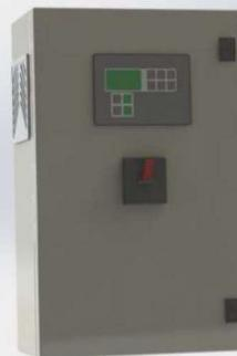
QE con centralina elettronica di comando e controllo Alternatore e Motore. Previsto il controllo interno presenza rete. In modalità AUTO alla mancanza rete, effettua l'avviamento del GE e automaticamente comanda lo scambio rete/gruppo. In alternativa può essere avviato da contatto remoto o in modalità MAN. Provvisto di selettore a chiave per attivazione logica, cicalina tacitabile, caricabatteria automatico, ed interruttore magnetotermico.
