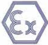
Appareil non électrique destiné à être utilisé en atmosphères explosibles
